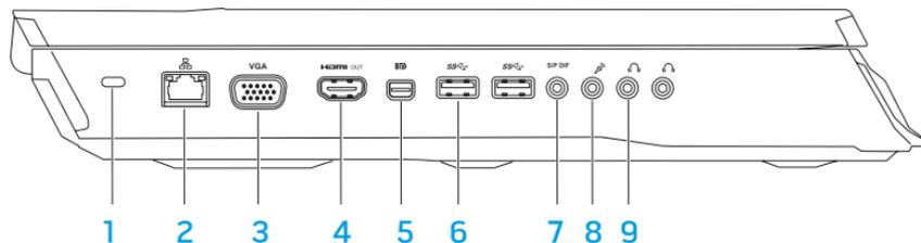
**1 Emplacement pour câble de sécurité** : permet de brancher sur l'ordinateur un câble de sécurité du commerce.
